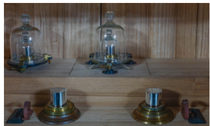
図2 キログラム原器(上段中央)、キログラム副原器(上段左)と真原器(下段左および右)(©産総研)
