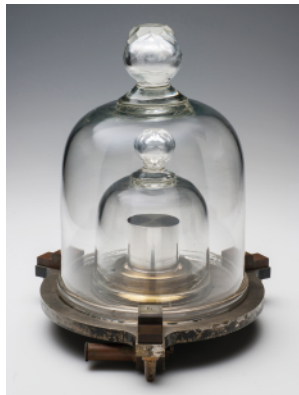
図1 明治、大正、昭和、平成、令和にわたる約130年間、日本の質量の国家標準であったキログラム原器(©産総研)
