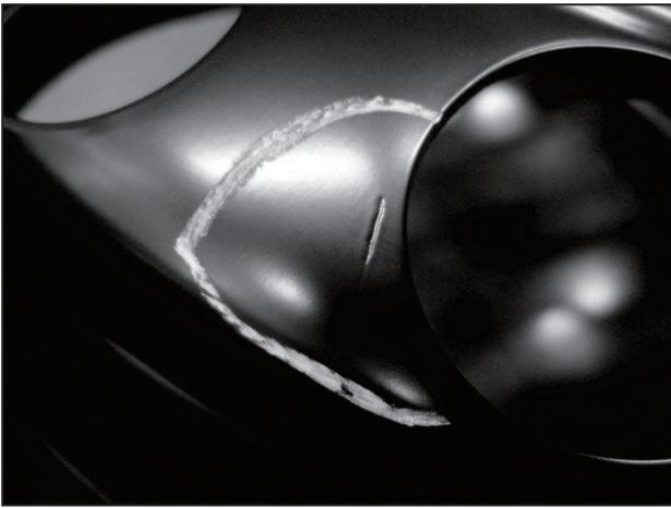
図8 代表的なサンプルワーク（かみ込みキズ）と使用した判定用紙
