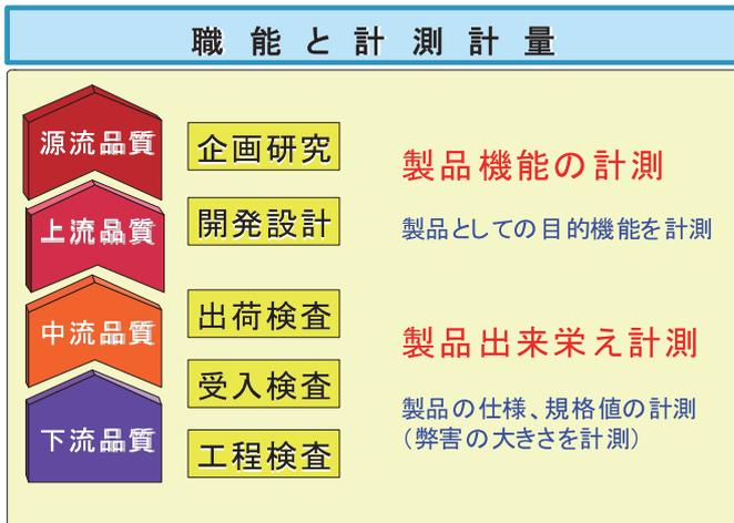
一般的な事業場における職能と計測計量の関連を考察すると企画研究／開発設計（源流・上流の品質）では、顧客が製品に期待している目的機能を正しく計測のパラメーターに変換（計測項目、代用特性値の決定等）し計測することであり、出荷検査／受入検査／工程検査（中流・下流の品質）では、製品の出来栄え（仕様、規格値）の計測といえる。
