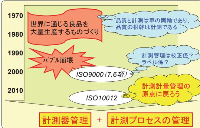
1970 年台、一般的な事業場では世界に通じる良品を大量生産するものづくりの掛け声の元、品質と計測は車の両輪とされ、計測の重要性が広く認識されていた。1990 年代の ISO 9000 シリーズの拡大と共に計測管理は計測器のみの管理（トレサビリティ、校正、識別ラベル、記録）に重きを置く傾向が強まり、本来は重要な計測プロセスの管理がおろそかにされてしまったのではないかとさえ考えている。計測計量管理の原点回帰（計測器管理）→（計測器管理+計測プロセスの管理）を目指し、ISO 10012 要求項目の具体的事例として紹介をする。
