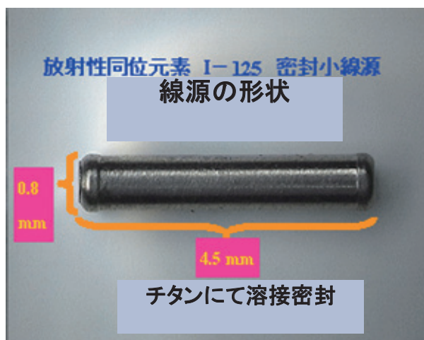
図1 ^{125}\text{I} 密封小線源の形状 1)
