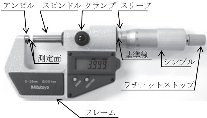
のような形状であり、半円形またはU字形をしたフレームの一方に固定測定面（アンビルと呼ぶ）を設けて、この測定面に垂直に移動するスピンドルの端面が移動測定面になっていて、このスピンドルの移動量を示すための目盛りが 0.5 mm 刻みでスリーブに、0.01 mm 刻みでシンブルに付けてあります。
