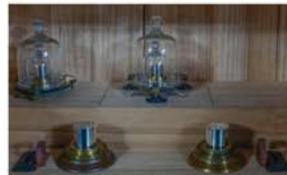
図2 キログラム原器(上段中央)、キログラム副原器(上段左)と貰原器(下段左および右)(©産能研)
